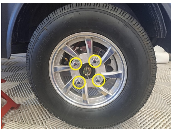
Irrota pyörän kiinnitysmutterit. (hylsy 19 mm).
